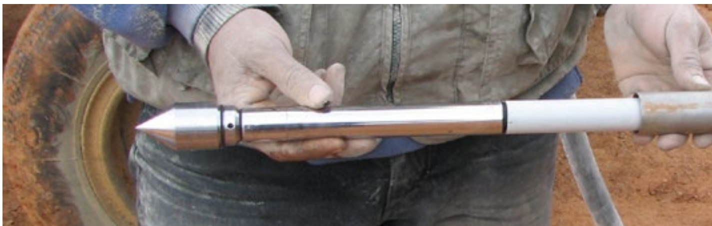
Piezómetro drive-in con varilla de empuje
